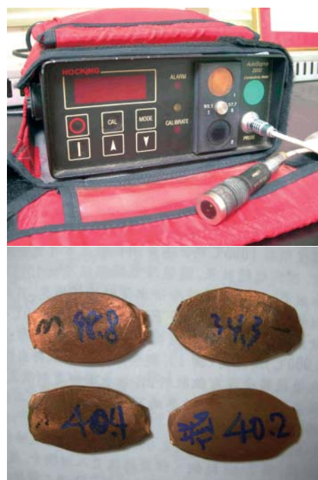
渦電流式之導電率量測，鑄線之導電值 (IACS)
